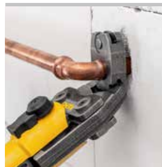
Пресс-шайба REMS S (PR-2B), плавно поворачиваемая
