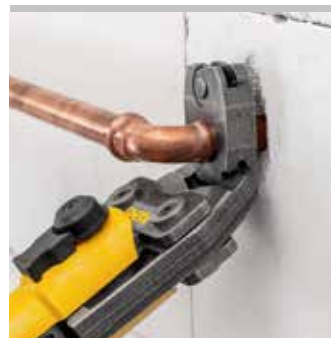
Пресс-шайба REMS S (PR-2B), плавно поворачиваемая
