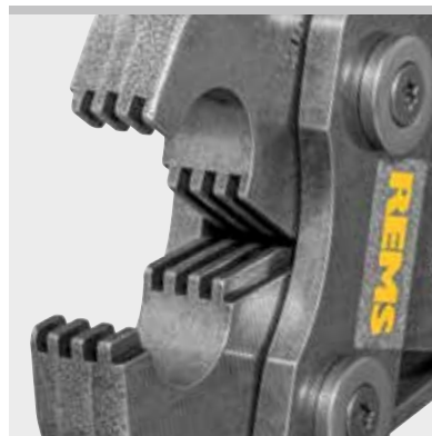
Обжимные клещи с зубчатым зацеплением предотвращают образование заусенцев на пресс-фитинге. Патент EP 2 027 971
